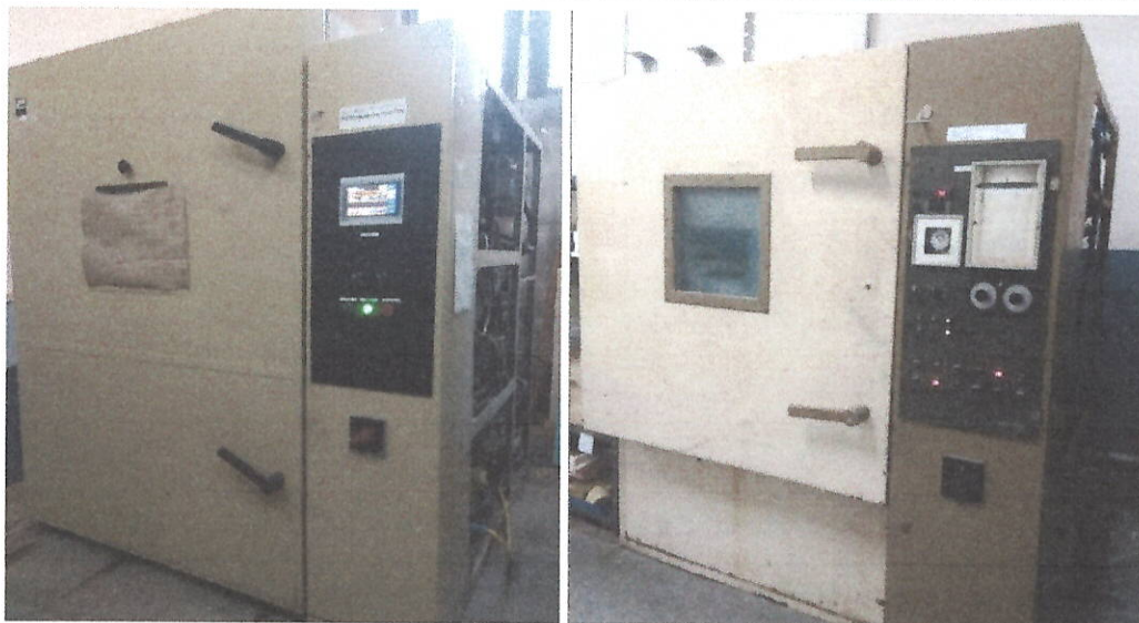
Рисунок 3 – Кліматичні камери для проведення циклічних кліматичних впливів
