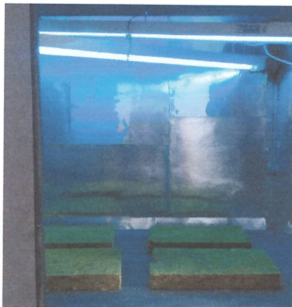
Рисунок 7 – Загальний вигляд дослідних зразків теплоізоляційного матеріалу марки «ТЕХНОВЕНТ Н» під час опромінення
